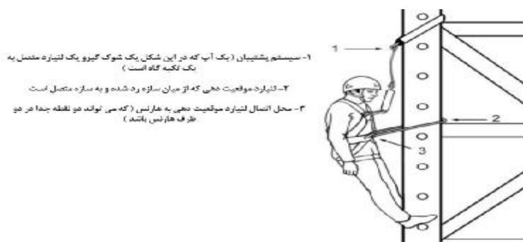
شکل 7- سیستم های موقعیت دهی به کار در سطوح عمودی
