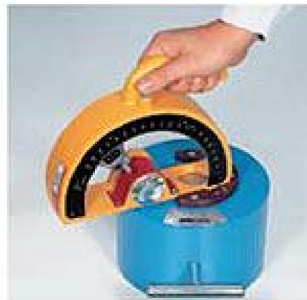
شکل 41- نحوه کالیبراسیون چکش اشمیت معمولی و شاقولی
