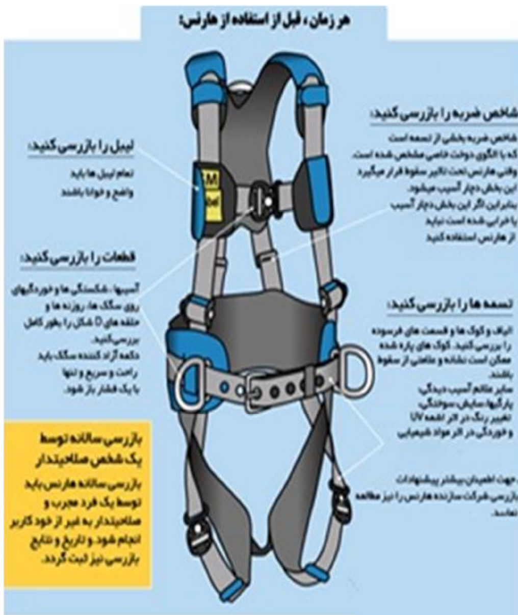
شکل 6: بررسی های مورد نیاز کمر بند هارنس
