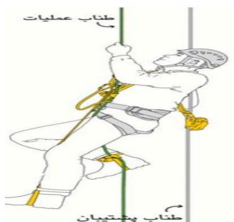
شکل 16- نحوه استفاده از طناب عملیات و طناب پشتیبان
