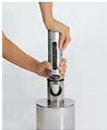
شکل 41- نحوه کالیبراسیون چکش اشمیت معمولی و شاقولی
